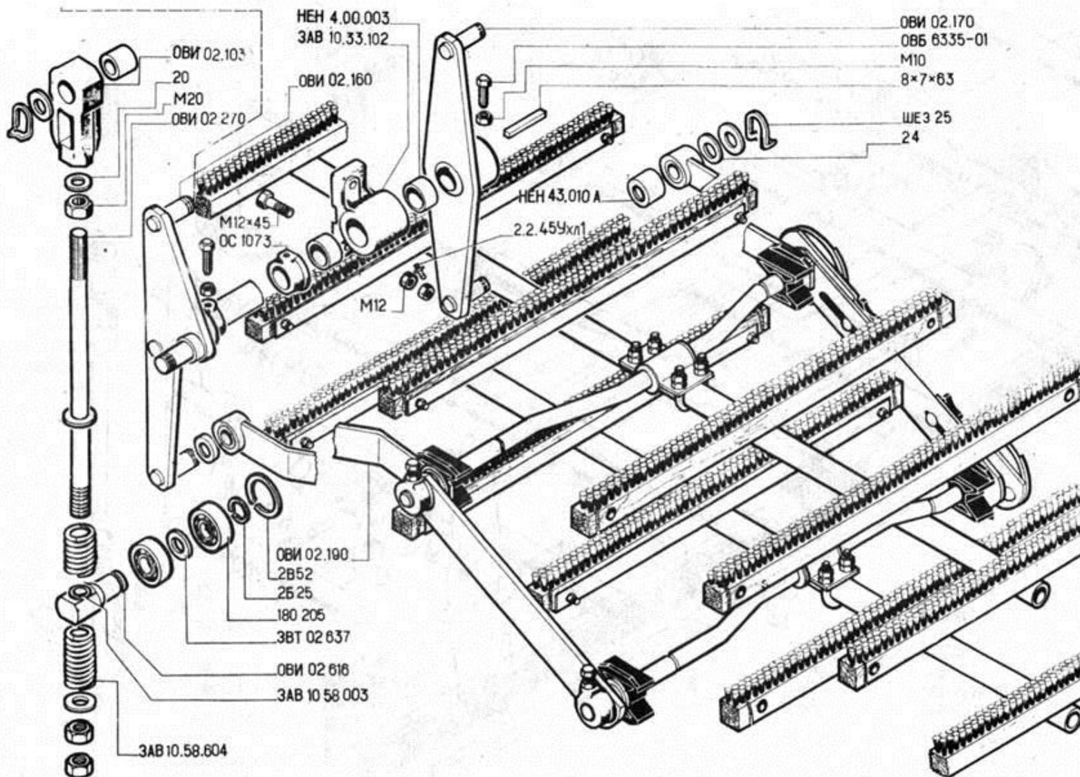
Рис. 12. Механизм очистки решет ОВИ 02.150.
